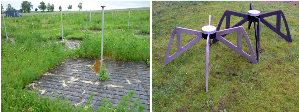
Figuur 2: Links: De lage-frequentie Low Band Antennas (LBA) zijn operationeel tussen 30 en 80 MHz (foto T. Krieg). De door de antennes ontvangen signalen worden in een computercontainer, linksboven op de foto, gecombineerd, voordat de gegevens naar de supercomputer in Groningen getransporteerd worden voor verdere verwerking. Rechts: De hoge-frequentie High Band Antennas (HBA) zijn operationeel tussen 120–240 MHz.
