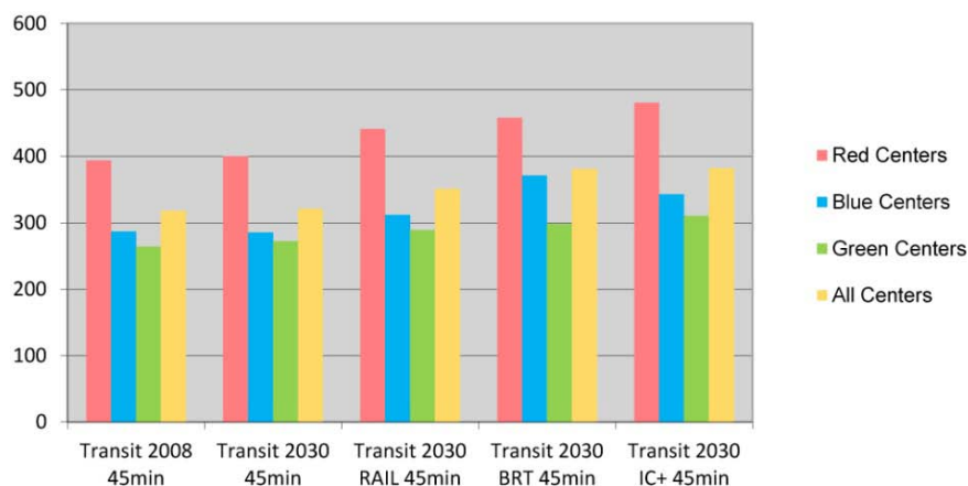
Figuur 3: Bereikbaarheid van de centra in scenario's: absoluut aantal inwoners x1000 dat centra kan bereiken met het openbaar vervoer in 45 minuten, per type centrum
