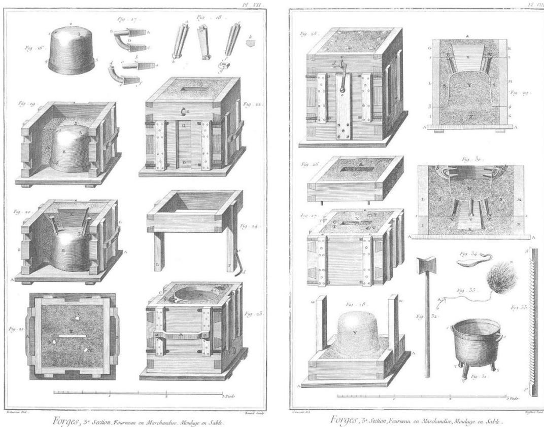
Fig. 1.18. Engraved plates VII & VIII from *Moulage en sable*. Forges ou art du Fer. Troisième section; Denis Diderot, *Encyclopédie ou Dictionnaire raisonné des sciences, des arts et des métiers*, Vol. 4, plates, 1765
