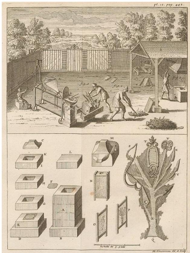
Fig. 1.17. René-Antoine Ferchault de Réaumur, Paris, 1722. Engraving illustrating iron casting in simple bi-valve sand moulds. The moulding sand is held in flasks clamped in a press. Plate 12 from Réaumur, René-Antoine Ferchault de, *L' Art de convertir le fer forgé en acier et l'art d'adoucir le fer fondu, ou de faire des ouvrages de fer fondu aussi finis que de fer forge*, 1722, 442.
