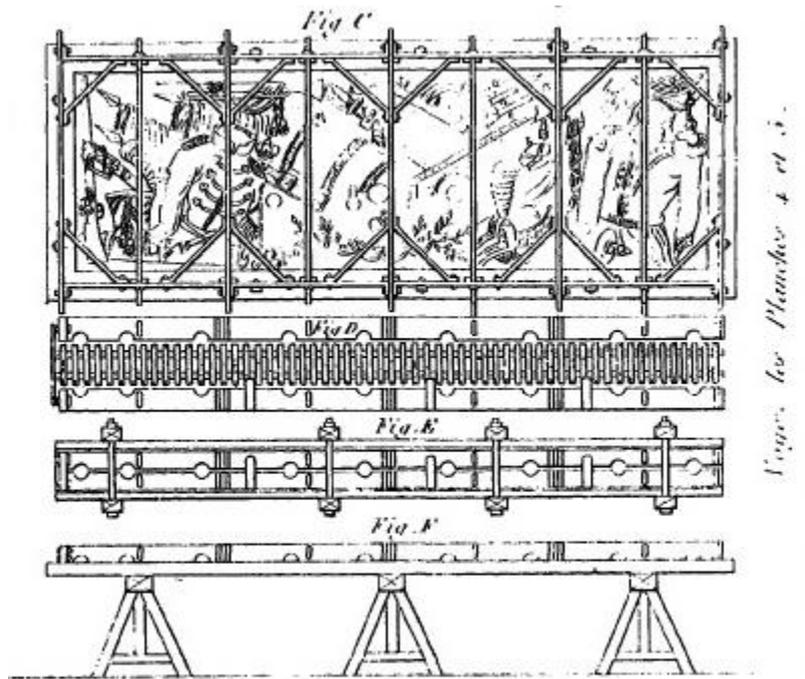
Fig. 2.4. *Détails relatifs à la fonte de la Colonne de la place Vendôme*, Detail from plate 7, illustrating the sand mould of a large bronze relief, Launay, *Manuel du Fondeur*, Paris, 1827, volume I.
