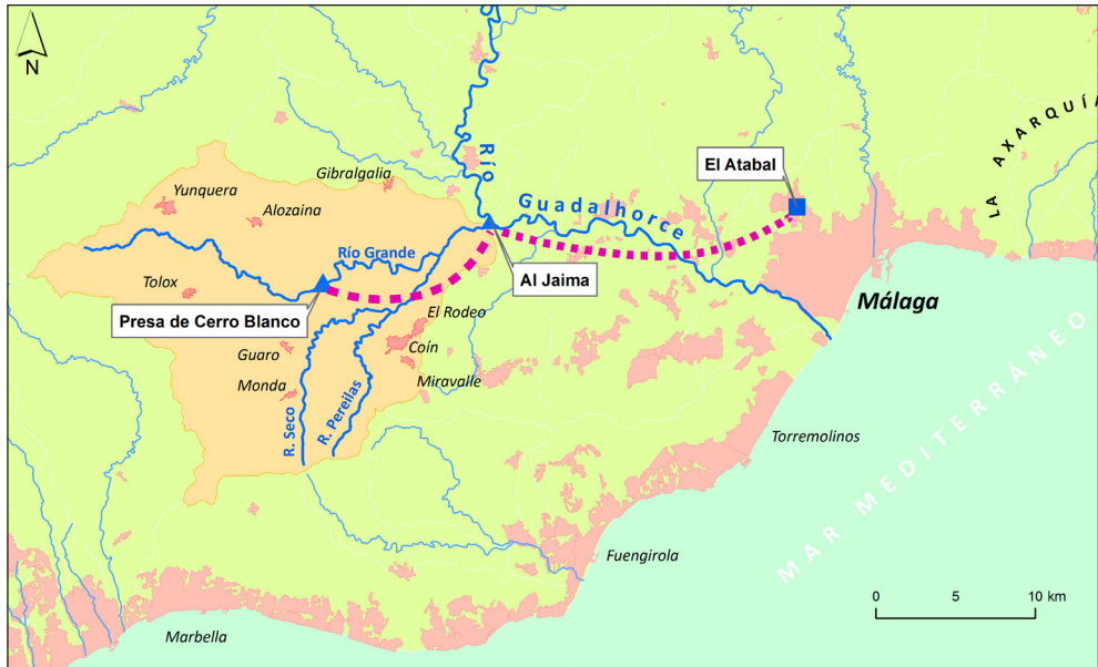
Figura 1. Esquema de las posibles obras hidráulicas en Río Grande. A la izquierda, la posible construcción de la presa de Cerro Blanco, también lugar del Azud con el tubo propuesto (38 km): el posible canal de conducción para transferir aguas rurales hacia Málaga. Sobre la derecha, la obra definitiva, canal de conducción de 21 km que une el Azud de Al Jaima con la planta desaladora de El Atabal.
