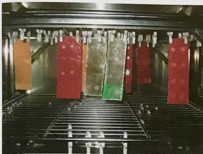
Fig. 2 : échantillons en chambre climatique
