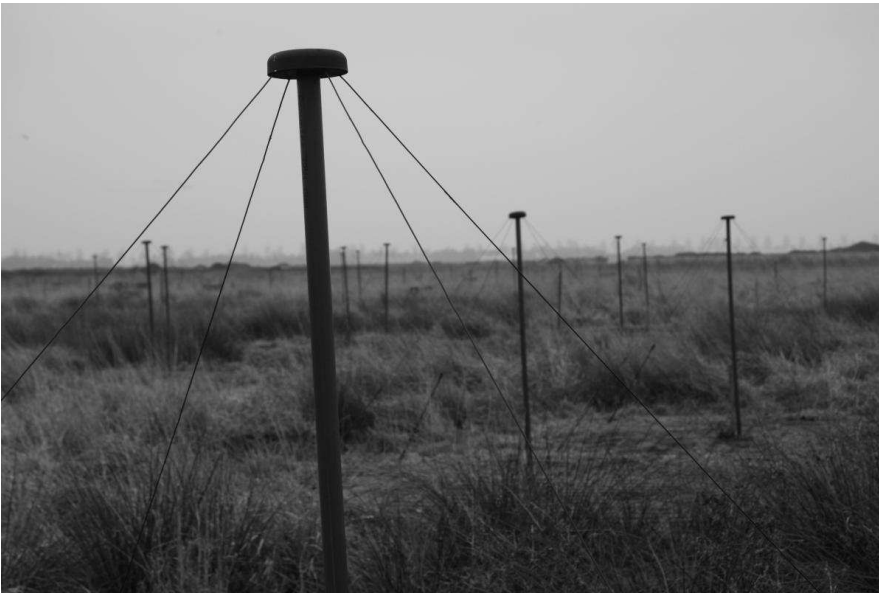
Figure 7.2: De Lage Frequenties Antennes van LOFAR zoals ze momenteel bij Exloo (Drenthe) staan opgesteld. Ze zijn vooral gevoelig bij frequenties tussen de 30 en 80 MHz.
