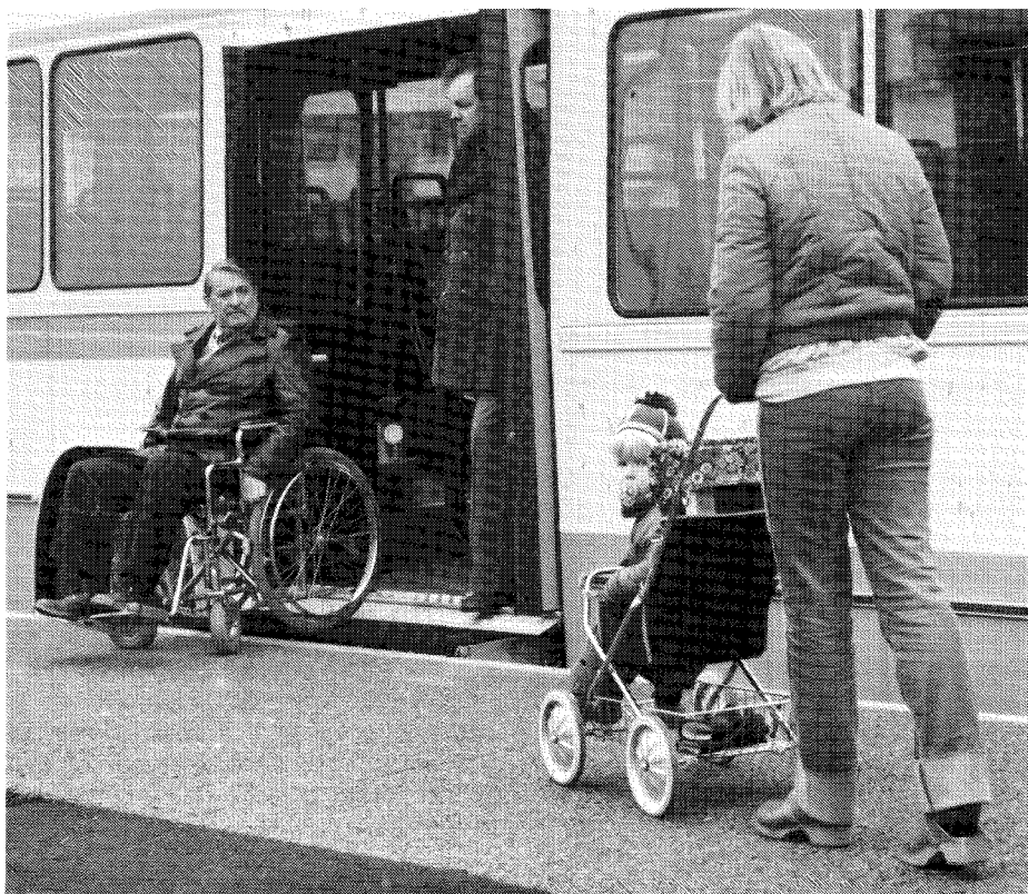
Gelijkvloers van het verhoogde perron de bus in: dat kan in het Zweedse Halmstad.
